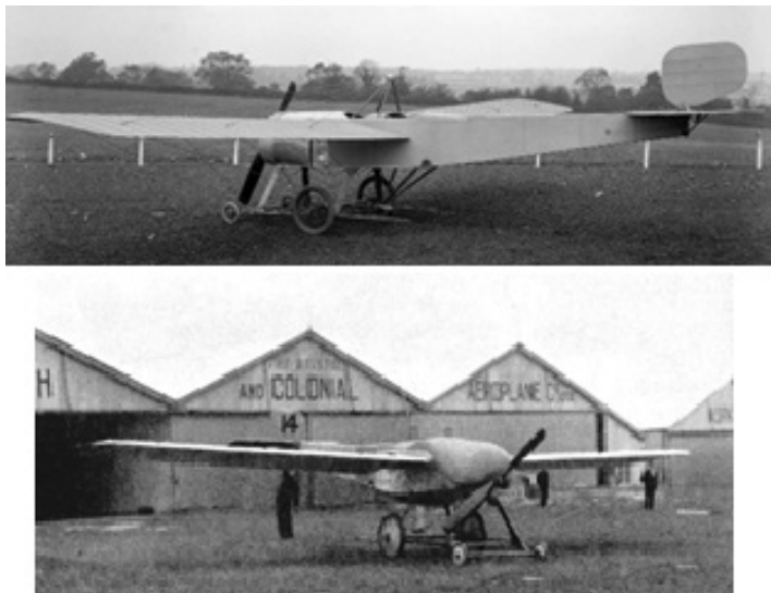
Fig. nr. 4 – Modelul Coanda School Monplane (sus) în iarna anului 1912. Modelul militar de monoplan Bristol-Coandă (jos). Influența conceptuală a Coandă-1910: fuselajul aerodinamic și ampenajele profilate aerodinamic.
