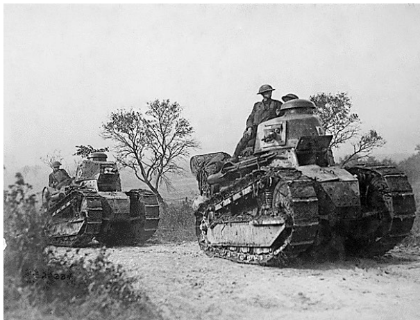
Fig. nr. 2 – Renault FT-17, aici în dotarea trupelor americane, este considerat a fi primul tanc modern din lume
